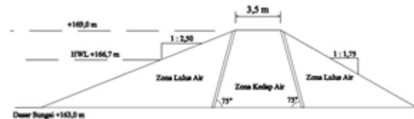
**Gambar 9. Tubuh Embung Tipe Urugan Zonal dengan Inti Kedap Air Vertikal**
